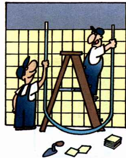
Fig. 7-17: Os pedreiros usam uma mangueira com água para nivelar os azulejos nas paredes, por exemplo.
