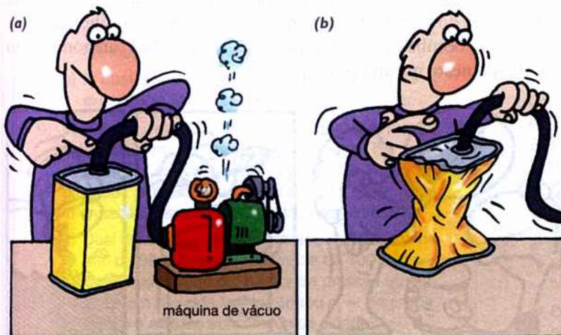
Fig.7-6: A pressão atmosférica é capaz de esmagar uma lata no interior da qual foi feito o vácuo.
