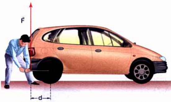
Fig. A-4: A chave de roda é um dispositivo usado para aplicar um torque ao parafuso de fixação da roda.
