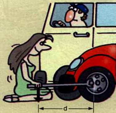
Fig. 7-39: Para desapertar (ou apertar) o parafuso da roda, a pessoa fará um esforço menor se usar uma alavanca mais comprida.
