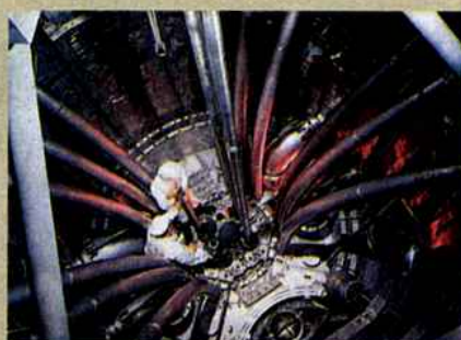
Fig. 8-30: Em um reator atômico (de uma usina nuclear, por exemplo) a desintegração em cadeia dos átomos de urânio se processa sob controle.
